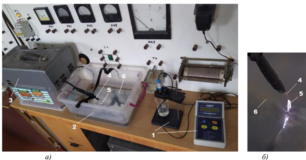
Рис. 1 – Загальний вигляд установки для обробки води високою напругою постійного струму а – установка для обробки води; б – коронний розряд між двома електродами; 1 – рН метр; 2 - лоток з водою, що обробляється; 3 – генератор високої напруги постійного струму; 4 – коронуючий електрод (негативний потенціал); 5 – коронний розряд; 6 – осаджуючий електрод (позитивний потенціал)
